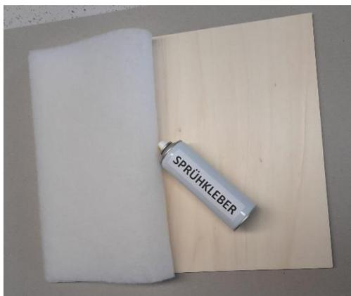
Die Watte wird auf die nicht markierte Holzplattenseite mit Sprühkleber geklebt.
