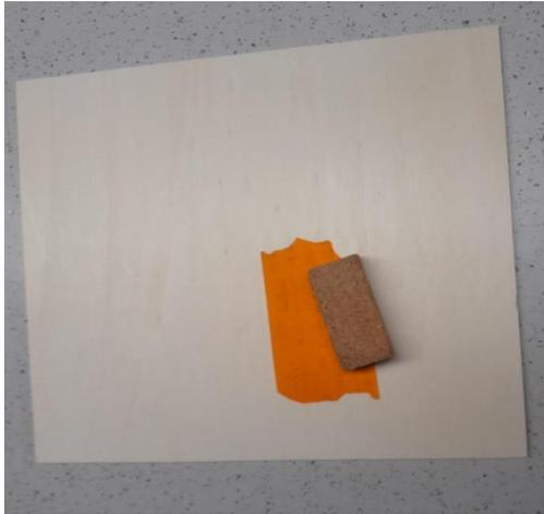
Bei der Holzplatte haben wir uns für eine Pappel Multiplexplatte entschieden. Diese ist leicht und trotzdem stabil.
